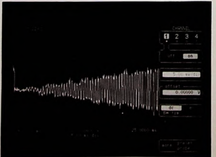
Fig. 10 HP54501A, monotonieit van een DA-converter. Weliswaar niet precies dezelfde converter als in fig. 3, maar het verschil in horizontale resolutie is zichtbaar (hier 512 punten).
