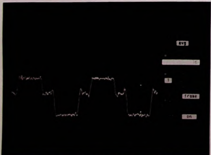
Fig. 8 HP54501A, hetzelfde signaal als van fig. 7 maar nu na 16x middelen van de binnenkomende signaalvorm. Een krachtige functie van de HP! Rechts het desbetreffende menu.
